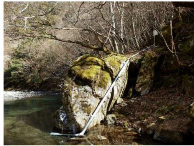
水位計設置状況
