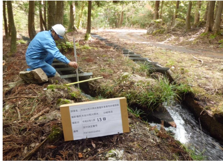
流量測定状況
