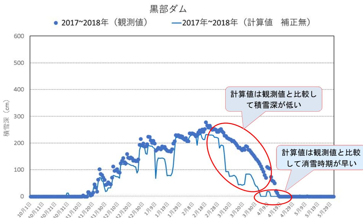
図 4.8-6 黒部ダム地点における積雪・融雪モデルによる計算結果と実績積雪深の比較
